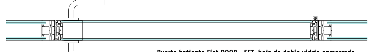
Puerta batiente Flat D00R - SET, hoja de doble vidrio enmarcado Porta batente Flat D00R - SET com folha de vidro duplo encaixilhado Hinged door, Flat D00R - SET double glazed, aluminium framed leaf Porte battante Flat D00R - SET avec panneau de double verre encadré
