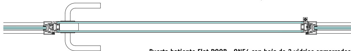
Puerta batiente Flat D00R - ONE4 con hoja de 2 vidrios enmarcados Porta batente Flat D00R - ONE4 com folha de 2 vidros encaixilhados Hinged door, Flat D00R - ONE4 with double-glazed leaf, alum. framed Porte battante Flat D00R - ONE4 avec panneau de deux verres encadrés
